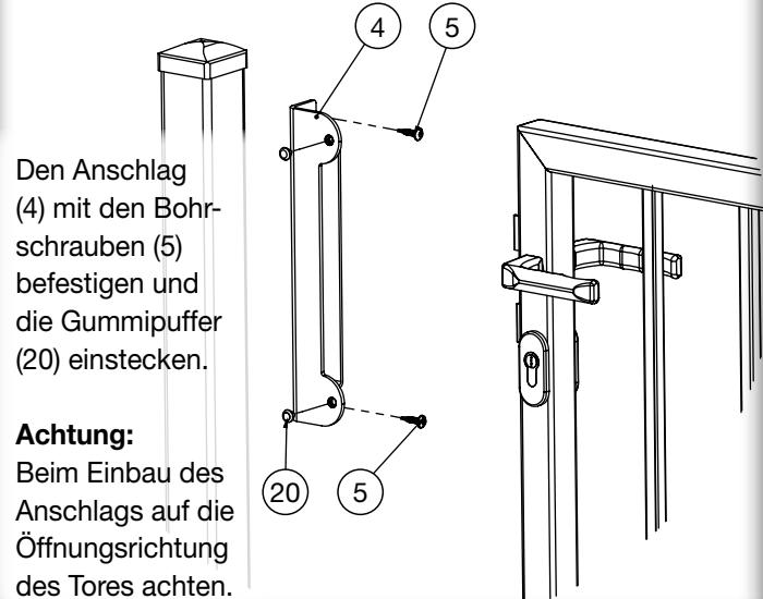
Den Anschlag (4) mit den Bohrschrauben (5) befestigen und die Gummipuffer (20) einstecken.
