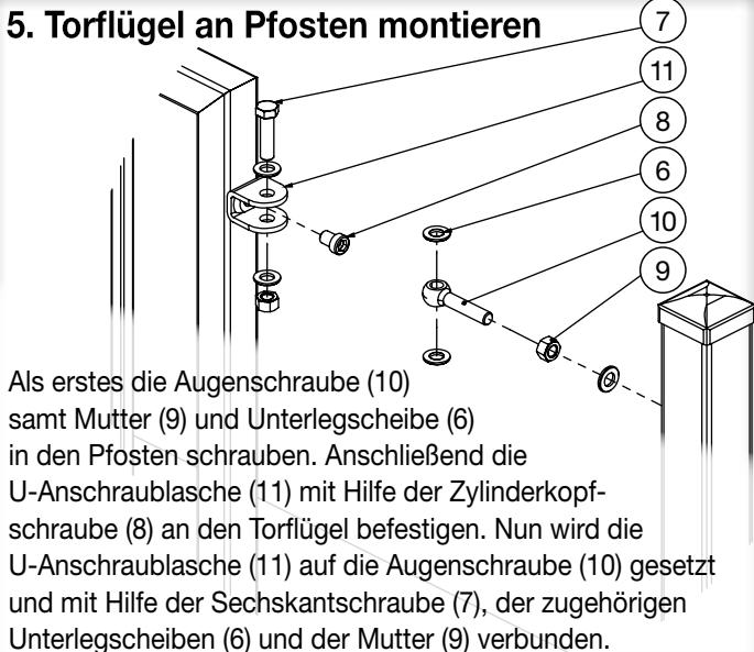
Als erstes die Augenschraube (10) samt Mutter (9) und Unterlegscheibe (6) in den Pfosten schrauben. Anschließend die U-Anschraublasche (11) mit Hilfe der Zylinderkopfschraube (8) an den Torflügel befestigen. Nun wird die U-Anschraublasche (11) auf die Augenschraube (10) gesetzt und mit Hilfe der Sechskantschraube (7), der zugehörigen Unterlegscheiben (6) und der Mutter (9) verbunden.
