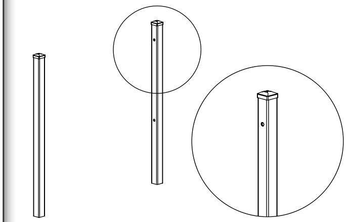
Bei der Pfostenmontage darauf achten, dass die angebrachten Einnietmuttern des Scharnierpfostens in Richtung der Tordurchgangsöffnung zeigen.
