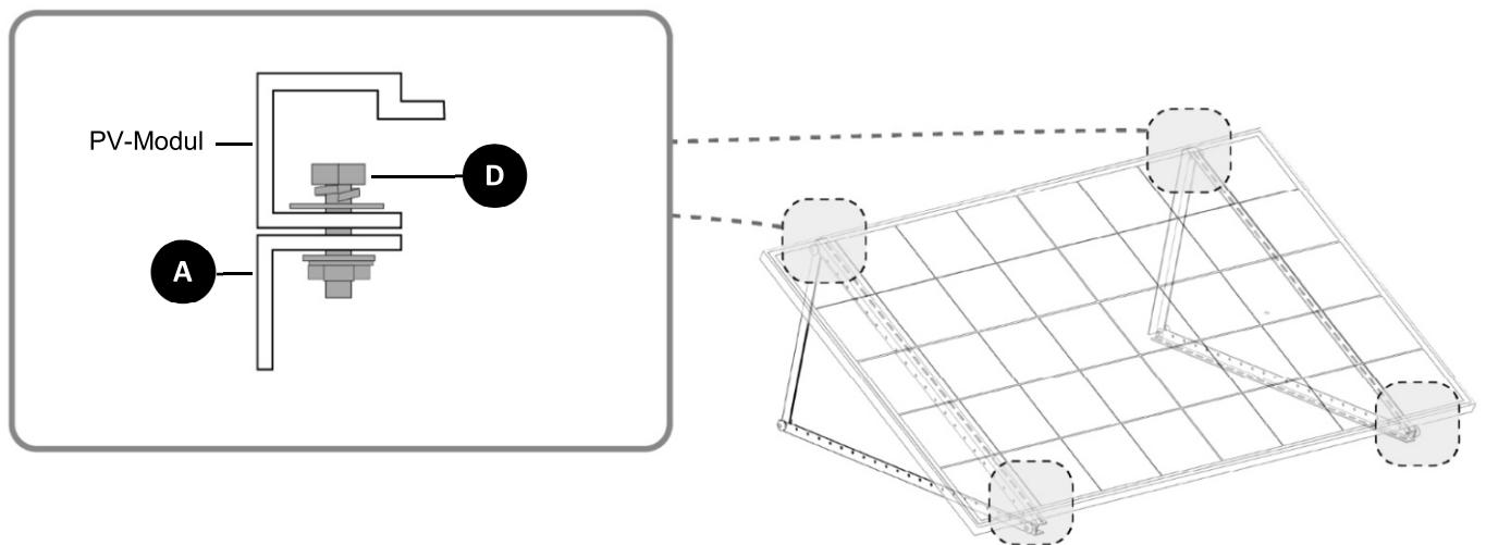
**Hinweis:** Der Neigungswinkel kann durch die unterschiedliche Montage des Winkelprofils (D) variiert werden.
