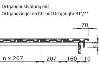
\* Laut dem Regelwerk des ZVDH soll bei Ortgangziegeln der Abstand zwischen Innenkante Ortgangplatten und Außenkante Giebelwand bzw. Außenkante Bekleidung mindestens 1 cm betragen.
