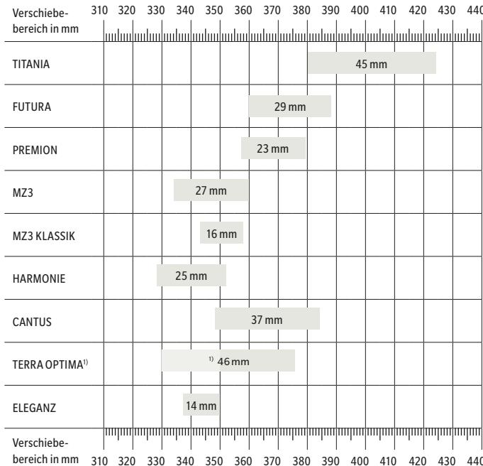
1) Ortgang muss bei einer Decklänge von 330 bis 350 mm ausgeklinkt werden.
