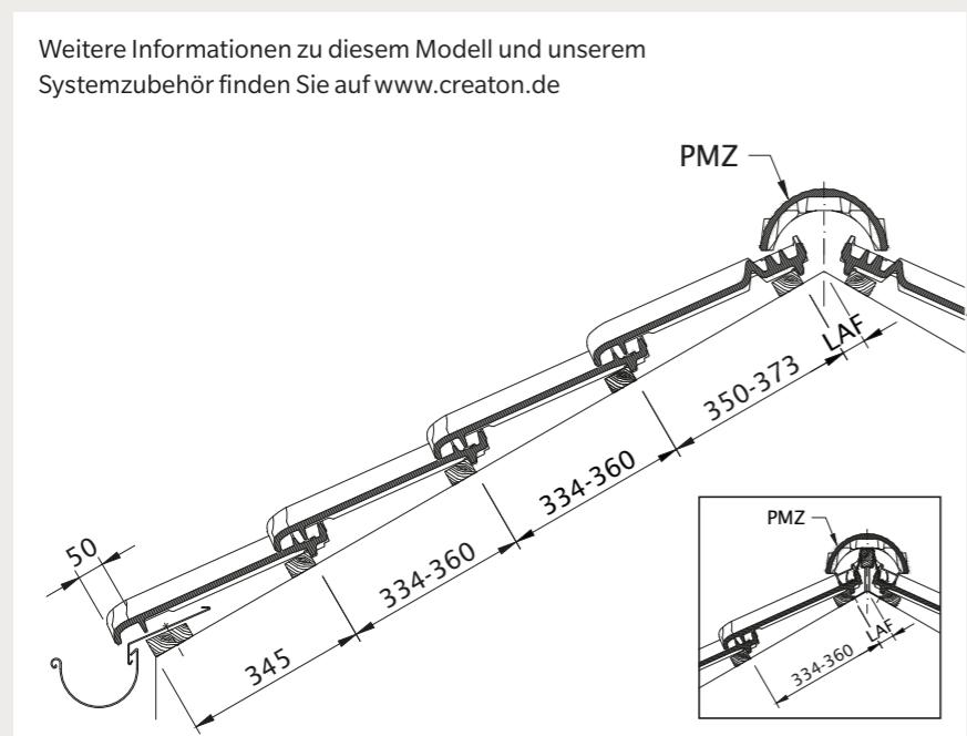
Dachquerschnitt Entlüftung über FALZ\*. Firstziegel trocken verlegt. LQ bis ca. 230 cm<sup>2</sup>/m. First. Nach DIN 4108 bis 23 m Sparrenlänge. Trauflattenabstand variabel.
