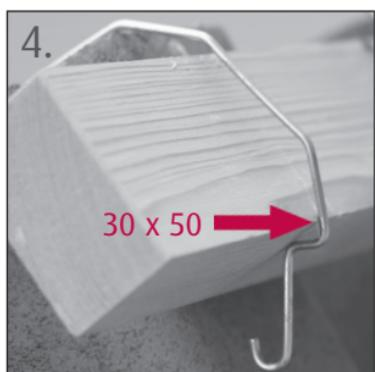
Bei Lattung 30 x 50 mm die Klammer bis zur zweiten Raste herunterdrücken.
