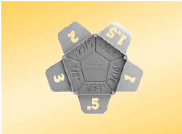
Der IndorTec® FA Fugenabstandshalter sorgt für eine einheitliche Fugenoptik bei kalibrierten, rektifizierten Fliesen und Naturstein. Es sind Fugenbreiten von 0,5 bis 3 mm möglich. Durch Kombination von zwei Fugenabstandshaltern sind Fugenbreiten bis 6 mm möglich. Mit einer Abstufung von 0,5 mm gewährleistet der Fugenabstandshalter ein gleichmäßiges Fugenbild.
