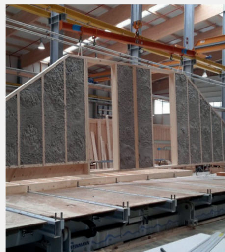
Die Fasern verfilzen sich im Bauteil zu einer maßgeschneiderten Dämmmatte.
