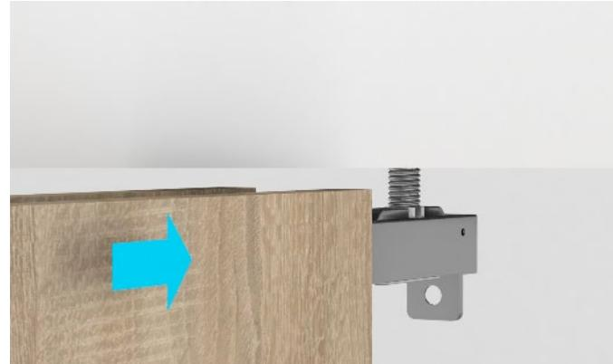
Bild 5: Aufhängung und Schiene mit Schraube 4x18 verschrauben.
