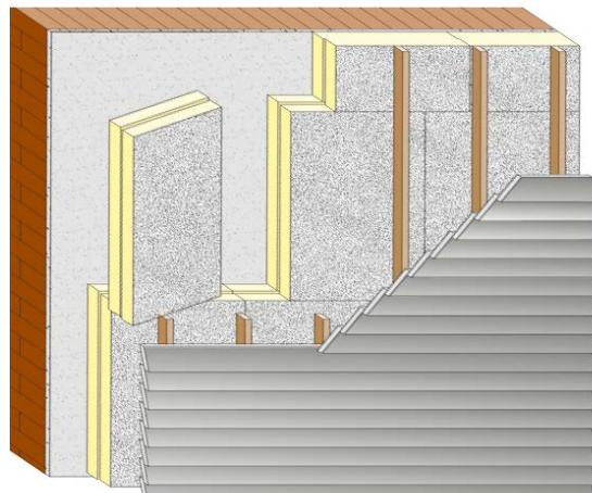
Die Dämmelemente LINITHERM PAL W werden zusammen mit der Unterkonstruktion an die Fassade geschraubt. So entsteht eine homogene Dämmschicht. Die beidseitige Alukasierung verhindert das Eindringen von Feuchtigkeit. Der Dämmwert bleibt erhalten. Weitere Informationen zur Montage entnehmen Sie bitte den Hinweisen zur Verlegung.
