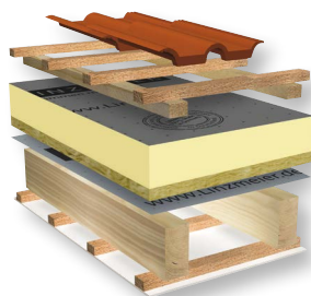
Altbausanierung oder Neubau LINITHERM PAL 2UM Aufsparrendämmung mit raumseitiger Verkleidung
