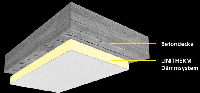
Durch die zum System gehörenden LINIFIX Befestigungsklammen und einer umlaufenden Nut- und Federverbindung lassen sich die Elemente schnell und sauber anbringen.
