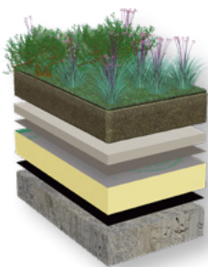
Dämmung unter Gründach
