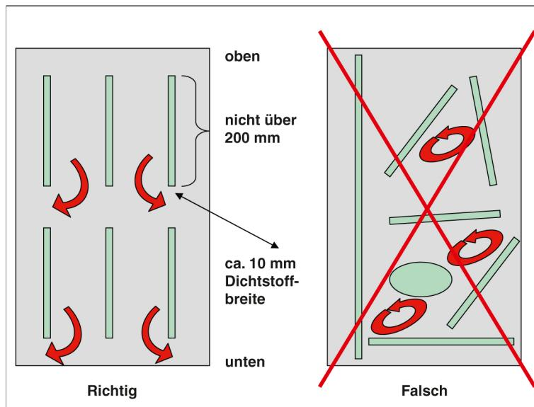
Bei der Montage von Spiegeln an Decken und bei der Wandmontage von Spiegeln, deren Oberkante über 4 m über der Bodenfläche liegt, müssen die Spiegel zusätzlich mechanisch z.B. durch Schrauben bzw. Einlegen in Rahmen gesichert werden.
