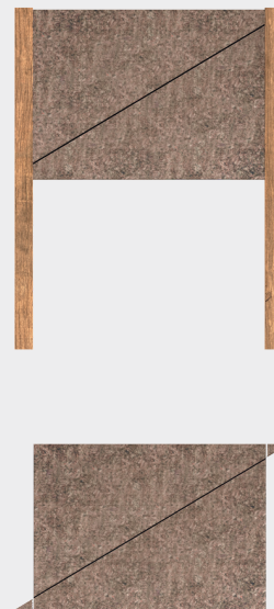
Lichter Sparrenabstand 60-90 cm erforderliches Übermaß 1-2 cm
