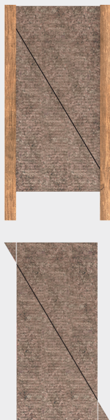
Lichter Sparrenabstand < 59 cm erforderliches Übermaß 1-1,5 cm
