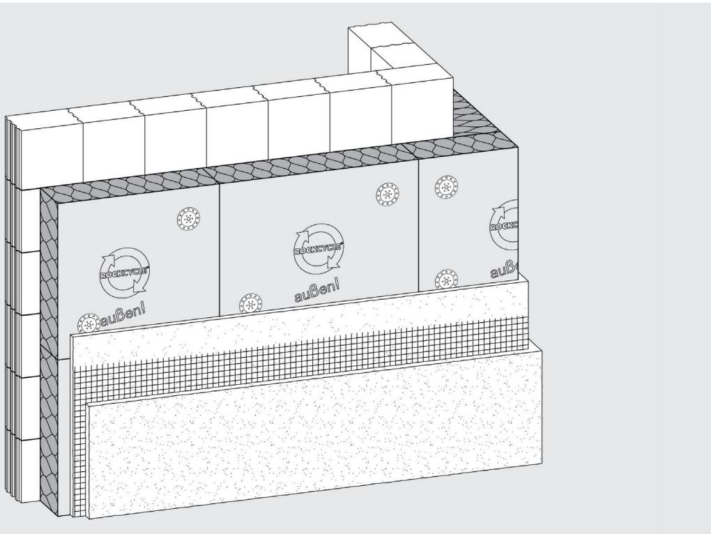
Nichtbrennbare Steinwolle\*-Putzträgerplatte als Kernstück für Wärmedämm-Verbundsysteme. Die Beschichtung auf den Plattenoberflächen ermöglichen die maschinelle Verarbeitung des Klebemörtels auf dem Untergrund sowie den Putzauftrag ohne Pressspachtelung.
