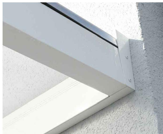
Den Sparren mit einem 4mm Metallbohrer vorbohren und die Blendkappen der Wandpfette mit jeweils 2 Schrauben (C101-025) montieren.
