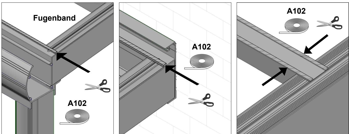
Kleben Sie das Fugenband auf die Enden des Profils der Rinnen- und der Wandpfette auf und schneiden es dann seitlich bündig mit den Sparren ab. Dann kleben Sie das Fugenband jeweils beidseitig an der Außenkanten der Hohlprofile für den Glasstoß entlang.
