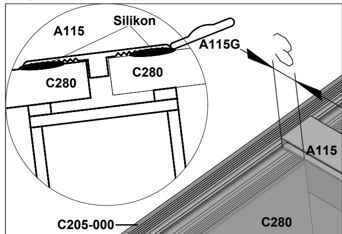
**Tipp:** Das Ergebnis der Verklebung des Profils ist später von der Terrasse aus sichtbar, testen Sie den Umgang mit einem Silikonspatel vorher an eine nicht sichtbaren Stelle.
