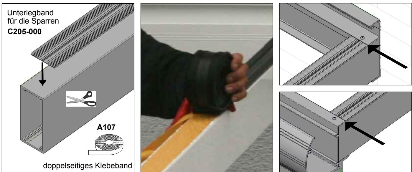
Das Unterlegband mit Hilfe des doppelseitigen Klebenbandes auf den Sparren verlegen. Lassen Sie das Unterlegband für die Sparren bündig am Hohlprofil für den Glasstoß und an der Wand- und der Rinnenfette enden.
