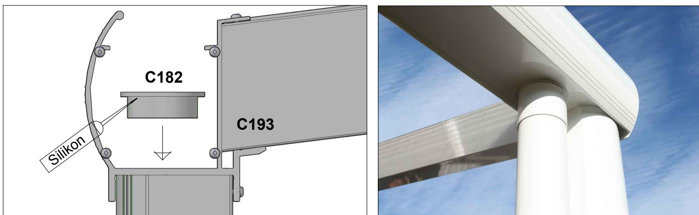
Vor der Montage den Stutzen auf der Unterseite mit einer durchgehenden Silikonschnur versehen.
