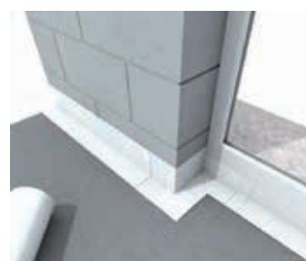
**11.** Nachdem alle anderen Vliese oder Formteile angepasst sind, kann mit der Applikation des Harzes begonnen werden.
