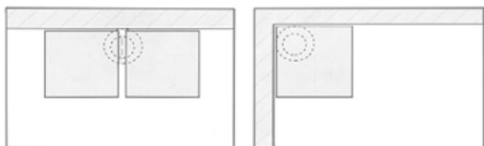
In Ecken oder an aufgehenden Bauteilen, sind die überflüssigen Halter mit Hilfe eines Cutters, einer Schneidezange oder einer Metallsäge zu entfernen.
