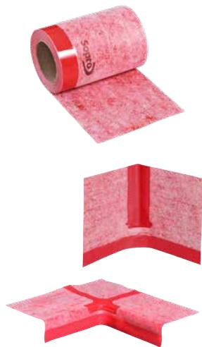
Flexibles, selbstklebendes, beidseitig mit einem speziellen Vliesgewebe beschichtetes Wannendichtband aus hochwertigem Polypropylen sowie multifunktionale Formteile mit flexiblen Dehnzonen für eine Vielzahl von einspruchsvollen Einbausituationen. Zur wasserdichten Anbindung von Dusch- und Badewannen an die Flächenabdichtung. Normkonform gemäß DIN 18534, keine Abdichtung hinter oder unter der Dusch- oder Badewanne notwendig.
