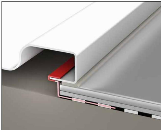
**11** Sonderfall: Soll die Duschwanne auf dem Fliesenbelag aufliegen, so sind Bänder und Formteile unterseitig bis in die Kantung des Wannenrandes einzukleben (dabei Duschwanne für die Montage wenden).
