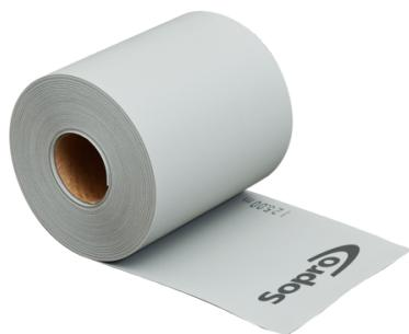
Innovatives, chemisch und mechanisch hoch beanspruchbares Premium-Dichtband ohne äußere Vliesbeschichtung zur sicheren, flexiblen und wasserundurchlässigen Überbrückung von Anschluss- und Bewegungsfugen in Kombination mit Sopro AEB® Abdichtungs- und EntkopplungsBahn HD unterhalb keramischer Fliesen und Platten sowie von Naturwerksteinfliesen.
