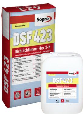
Zweikomponentige, faserarmierte, mineralische Dichtungsschlämme (MDS) zum Erstellen von flexiblen und rissüberbrückenden Verbundabdichtungen. Zur Abdichtung von Innenräumen gemäß DIN 18534, zur Abdichtung von Behältern und Becken gemäß DIN 18535 sowie zur Abdichtung von Balkonen, Loggien und Laubengängen gemäß DIN 18531 Teil 5.
