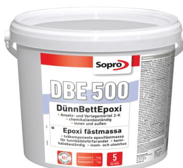
Zweikomponentiger Epoxidharzklebstoff, R2 T nach DIN EN 12004, zum Ansetzen und Verlegen von keramischen Fliesen und Platten. Bei Beanspruchungen durch aggressive Wässer, Chemikalien, Säuren, natürliche Fette, hohe Druck- und Spülbelastungen; in Schwimmbecken, Industrie- und Gewerbebereichen. Geeignet auf Wand- und Fußbodenheizungen und Verbundabdichtungen.
