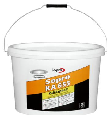
Einkomponentiger, lösemittelfreier, gebrauchsfertiger, kalt einzubauender Reaktivaspalt. Zur schnellen und dauerhaften Instandsetzung von Schadstellen wie Schlaglöchern und Frostausbrüchen. Zur Reparatur von Straßenbelägen, bei der Sanierung von Kanaldeckeln und Straßenablaufschächten, zur Instandsetzung von Fußwegen, Parkplätzen und Industrieböden aus Beton oder Asphalt. Hoch belastbar, auch bei hohen Temperaturen. Beständig gegen Frost und Regen.
