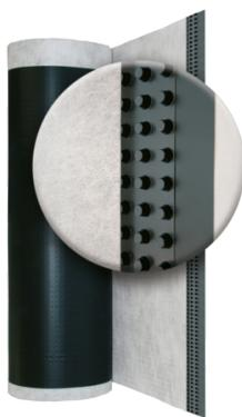
Bitumenverträgliche Drainage- und Schutzmatte mit rückseitig aufkaschierter, druckverteilender Folie und einem druckstabilen Polypropylen-Filtervlies. Optimaler Schutz für zuvor angebrachte Sopro Bauwerksabdichtungen. Die rückseitige druckverteilende Folie gewährleistet einen sicheren Schutz auch bei späteren Bodenbewegungen oder Setzerscheinungen.
