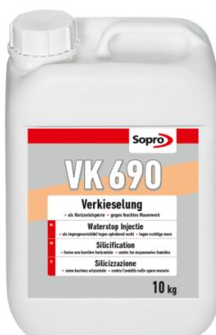
**Lössemittelfreie, einkomponentige Verkieselungslösung auf der Basis spezieller Silikate und hydrophobierender Zusätze. Im Bohrlochverfahren nachträglich einzubringende, verkieselnd und hydrophobierend wirkende Horizontal sperre gegen aufsteigende Feuchtigkeit im Mauerwerk. Zur dauerhaften Trockenlegung von feuchten Wänden.**
