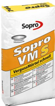
Zementärer, schnell erhärtender, schwindkompensierter, hoch fließfähiger Vergussmörtel mit schneller Festigkeitsentwicklung und hoher Frühfestigkeit. Zum Vergießen von Schachtrahmen und Ausgleichsringen, zum Fixieren von Schildern, Pfosten, Masten o. Ä. Zur Anwendung im Beton- und Sanierungsbau, für Industrieböden und Verkehrsflächen, die nach kurzer Zeit wieder für den Verkehr freigegeben werden sollen.
