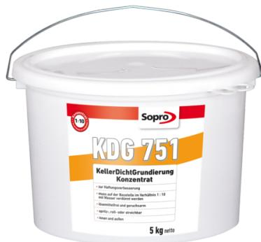
Lösungsmittelfreies, mit Wasser zu verdünnendes Voranstrich-Konzentrat auf Bitumen-Emulsionsbasis als Grundierung von saugfähigen und mineralischen Untergründen für nachfolgende Abdichtungen mit Sopro Bitumen-Dickbeschichtungen.
