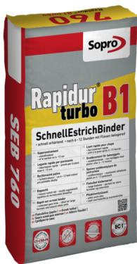
Kunststoffvergütetes, ternäres Spezialbindemittel zur Herstellung sehr schnell erhärtender, hochfester und früh belegereifer Zementestriche. Erreicht die Gütekasse CT-C50-F6 nach 28 Tagen (MV 1 : 4). Für Heizestriche, Verbundestriche, schwimmende Estriche und Estriche auf Trennschicht. Insbesondere für zeitsparende bzw. termingebundene Estricharbeiten. Wird an der Baustelle mit Estrichkiessand in geeigneter Sieblinie (z. B. 0 - 8 mm) gemäß DIN EN 12620 gemischt.
