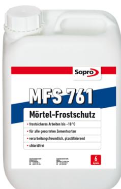
Chloridfreies, flüssiges Mörtelzusatzmittel zur Herabsetzung des Gefrierpunktes des Anmachwassers und zur Beschleunigung des Hydratationsverlaufes von Mörteln und Putzen. Wirkt verflüssigend, reduziert den Anmachwasserbedarf. Ermöglicht den Einbau von an Baustellen gemischten zementären Mörteln bis zu Lufttemperaturen von -10 °C. Alle genormten Zementsorten können verwendet werden. Sopro Mörtel-Frostschutz wird dem Anmachwasser zugesetzt.
