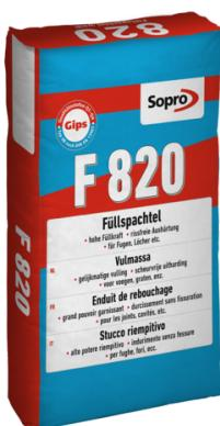
Spannungsarme, weiße, wasserdampfdurchlässige Spachtelmasse auf Gips-Kunststoffbasis zum Verfüllen von großflächigen Vertiefungen auf Mauerwerk, Putz-, Beton- und Gipskartonuntergründen sowie zum Verspachteln von Fugen bei Gipskartonplatten. Zum Füllen von Rissen, Löchern, Fugen und Schlitten. Für Fugenverspachtelung ohne Fugendeckstreifen, Typ 4B nach DIN EN 13963.
