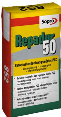
Zementgebundener, faservergüteter Betonersatz zur Reprofilierung und großflächigen Beschichtung von Betonuntergründen. Geprüft nach DIN EN 1504 "Produkte und Systeme für den Schutz und die Instandsetzung von Betontragwerken" sowie nach der ZTV-ING und den Instandsetzungsrichtlinien des DAfStb. Sehr standfester Reprofilierungsmörtel. Wird in die frische Haftbrücke aus Sopro Repadur MH eingespachtelt und lässt sich gut glätten.
