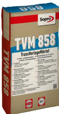
Hydraulisch erhärtender Trasszementmörtel zum Ansetzen und Verlegen im Dickbettverfahren nach DIN 18332, 18333 und 18352 von verfärbungsunempfindlichen Natur- und Naturwerksteinen wie z. B. Solnhofener Natursteinplatten, Jura-Marmor sowie Betonwerksteinen und Fensterbänken. Zum Ausgleichen von Untergründen aus zementären Werkstoffen wie Estrich und Beton in Mörtelbetticken von 10 - 40 mm. Verarbeitung in Verbindung mit Sopro HaftSchlämme oder Sopro HaftSchlämme Flex.
