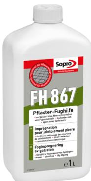
In Wasser gelöstes, hochalkalisches Produkt zur vorübergehenden Hydrophobierung von saugfähigen Pflastersteinen aus Beton- und Naturwerkstein. Die Flächen lassen sich dadurch leichter verfugen. Sopro Pflaster-Fughilfe dringt in das Kapillarsystem des mineralischen Pflastersteines ein und rüstet ihn wasserabweisend aus. Dadurch lassen sich Pflasterfugenmörtel leichter abwaschen. Auch als Abwaschhilfe für polygonal verlegte Naturwerksteine im Wand- und Bodenbereich.
