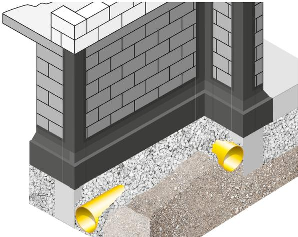
Der Übergang Bodenplatte-Kellerwand wird mit einem entsprechend zugeschnittenen breiten Streifen SoproThene® überklebt. Dabei darauf achten, dass ca. 10 cm des SoproThene® Eckbandes überlappt werden.
