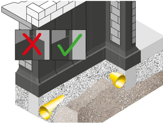
Es empfiehlt sich, Fläche für Fläche zu arbeiten und nicht um die Ecke zu kleben. Bei Bedarf eine Bahn SoproThene® in der entsprechenden Breite zuschneiden oder die Überlappung größer wählen.
