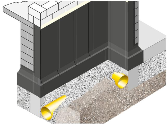
Um eine Unterwanderung durch Regen oder Wasser zu vermeiden, wird der obere Bahnenabschluss mit SoproThene® Abschlussband Vlies oder Abschlussband Aluminium ausgeführt.
