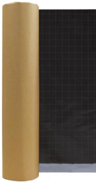
Flexible, rissüberbrückende, radondichte, kaltselbstklebende Bitumenabdichtungsbahn (KSK) aus kunststoffmodifiziertem Bitumen zur Herstellung von flexiblen, rissüberbrückenden Bauwerksabdichtungen gemäß DIN 18533 sowie zur Abdichtung von Balkonen, Loggien und Läubengängen gemäß DIN 18531.
