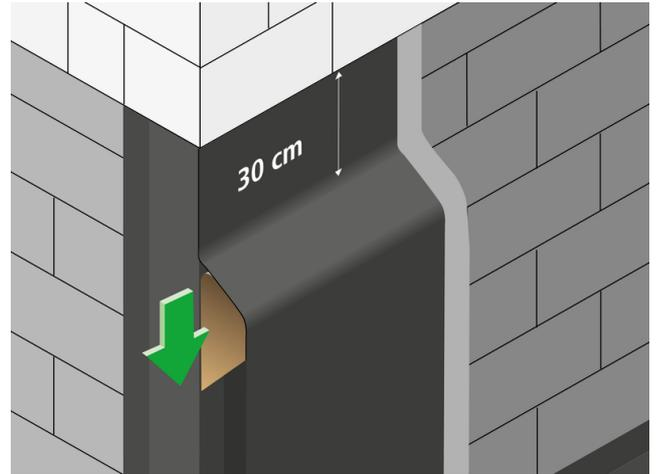
SoproThene® in der Länge zuschneiden und an der Ecke beginnend verkleben. Ca. 30 cm des Schutzpapiers abziehen. SoproThene® mit der klebenden Seite auf dem Untergrund ausrichten und andrücken. Anschließend das Schutzpapier weiter abziehen und SoproThene® aufkleben und andrücken. Die Bahn ist im Sockelbereich ca. 10 cm zu überlappen.
