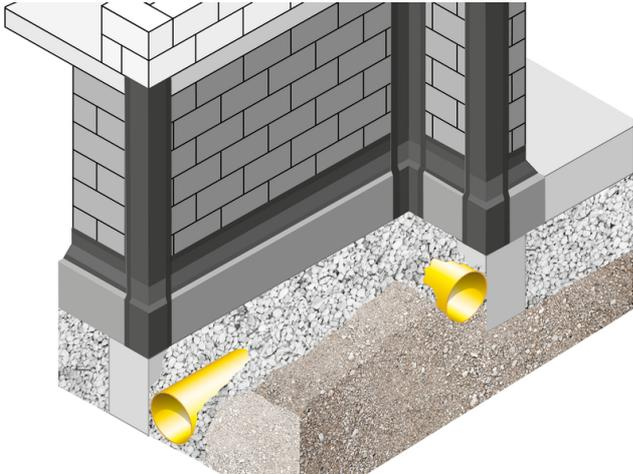
Auf die mit SoproThene® Voranstrich grundierete Kelleraußenwand wird SoproThene® Eckband auf die Innen- und Außenecken sowie die Hohlkehlen aufgeklebt. Anschlüsse überlappen. Vor dem Aufbringen von SoproThene® muss die Schutzfolie abgezogen werden.
