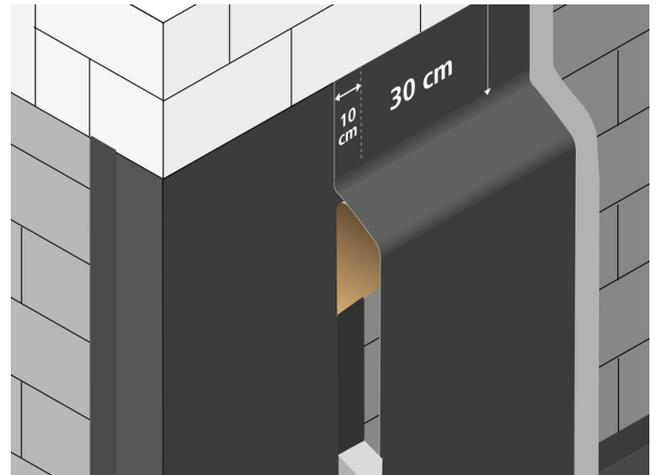
Jede weitere nachfolgende Bahn mit einer Überlappungsbreite von ca. 10 cm auf bereits verlegte Bahnen faltenfrei verkleben. Vorher ist die Schutzfolie des Vulkanisierungstreifens der zuvor verklebten Bahn abzuziehen.
