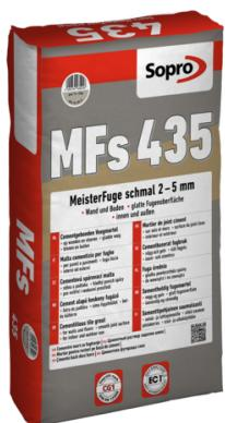
Zementärer Fugenmörtel, CG1 nach DIN EN 13888, besonders geeignet zur rissfreien Verfugung saugfähiger Steingutfliesen. Speziell hierauf abgestimmtes Ansteifverhalten, Wasserrückhaltevermögen und Abwaschbarkeit. Auch zum Verfugen schwach saugender Fliesen geeignet. Im Wohnbereich, im Lebensmittelbereich sowie in Trocken- und Nassbereichen. Auch geeignet auf Wand- und Fußbodenheizungen.
