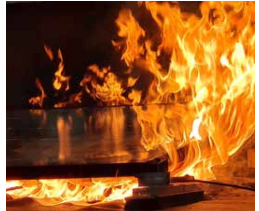
Lichtbogeninduzierter Brand unter Flachdach-Solaranlagen im ZAG-Brandversuchslabor
