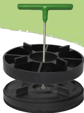
Abbildung 2: RT-V mit RT-5 und aufgesetztem VOLFI-Teller VT-U20, mit Stellschlüssel verst. Gesamthöhe= 35-40mm
