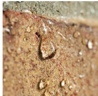
Watco Wasserabweisende Aussenbeschichtung dringt mit der Zeit tief ein. Daher kann es bis zu zwei Monate dauern, bis bei Regen eine merkliche Abperlung auftritt. Die Härtezeiten variieren in Abhängigkeit von der Porosität der Oberfläche und den Wetterbedingungen.
