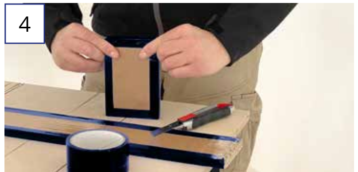
4 ECKEN UMSCHLAGEN Den Überstand an den Ecken nach unten umschlagen und den seitlichen Überstand in die Plattenfläche eindrücken.
