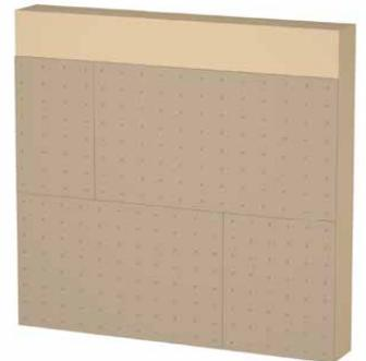
Dünne Holzfaserausbauplatte als Putzträger auf Holz- und Holzwerkstoffen. Die Platten können geschraubt oder geklammert werden. So entsteht auf Holz sehr einfach ein sicherer Untergrund für die Armierungslage aus Lehmklebe- und Armierungsmörtel und das nachfolgende Lehm-Finish.
