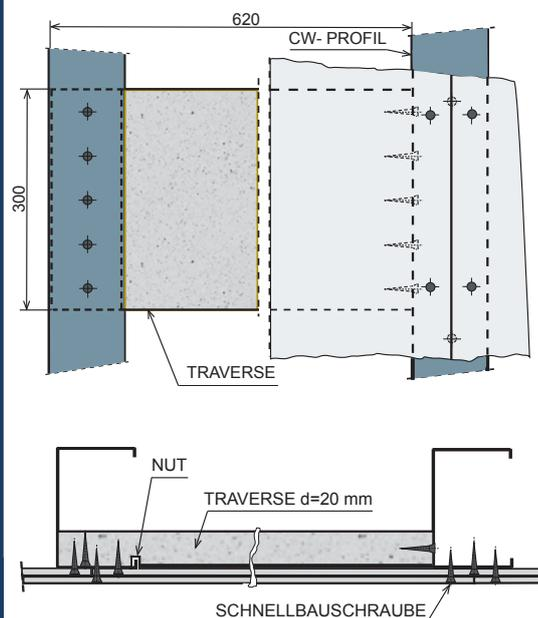
Geprüft gemäß DIN 18183-1:2009 mit Konsollasten bis 1,5 kN/m durch ein anerkanntes deutsches Forschungsinstitut.
