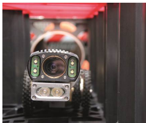
Inspection à l'aide d'une caméra téléguidée
