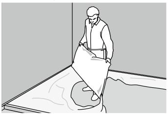
Staubex® plus wird zwischen zwei Hilfsstreifen geschüttet und mit Abziehlehren oder einer Richtlatte eben abgezogen. Die Mindestschütthöhe von 10 mm (auch über Unebenheiten oder Rohrleitungen) ist zu beachten. Um unerwünschte Verdichtung zu vermeiden, darf die Schüttung nicht betreten werden.
