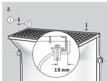
1. Gitterrost einlegen, Bohrungen rechts und links mittig auf Rostauflagefläche anzeichnen und 2 x Ø 10 mm bohren. Sicherungsdübel einsetzen.
