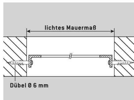
**Bei Einbau ohne Anschlag:** Befestigung mit vier Dübel
