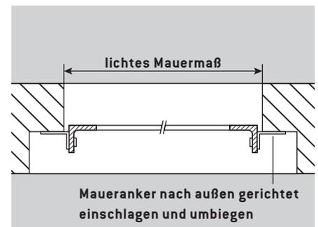
**Bei Einbau mit Anschlag:** Befestigung und Anschlag mit vier Mauerankern. Bei Mauerwerk mit Anschlag werden die Kellerfenster nach Einschlagen der Maueranker in die Leibung geschoben. Den Anschlag bilden die vier seitlichen Maueranker.
