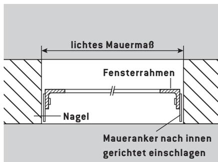
**Bei Einbau ohne Anschlag:** Befestigung mit vier Mauerankern
