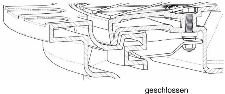
Der Arretierstift (A) verhindert ein unbeabsichtigtes Drehen des Deckels. Er muss beim Aufsetzen des Deckels in die Bohrung an der Schachtverlängerung oder dem Revisionschacht des Tanks gesteckt werden.
