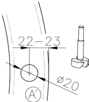
Bei Revisionschächten direkt am Tank ist die Bohrung für den Arretierstift werkseitig angebracht und die Ausrichtung des Deckels damit festgelegt. Wenn die Ausrichtung geändert werden soll, kann eine zusätzliche Bohrung A angebracht werden, siehe Abbildung links.
