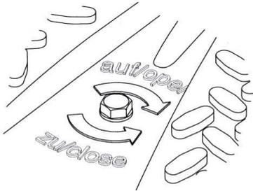
Durch Drehen am Sechskantkopf der Schraube an der Oberseite des Deckels wird der Riegel (B) betätigt und der Sicherungsriegel geöffnet oder geschlossen. Hierbei greift der Riegel in eine Tasche oder unter die Innenkante eines Revisionschachts fasst (Punkt 2.2.1) Es ist maximal nur eine Vierteldrehung nötig. Die Drehrichtung ist auf der Oberseite des Deckels angegeben.
