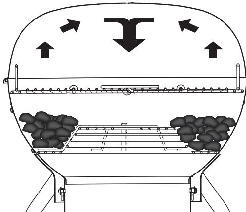
**Conseil:** Pour les viandes nécessitant plus d'une heure de cuisson, il est éventuellement nécessaire de rajouter du charbon de bois sur les côtés (voir tableau suivant). Grâce à la grille de barbecue rabattable, le réalimentation de charbon de bois s'effectue de façon simple. Attendez env. 10 minutes avec le couvercle ouvert, jusqu'à ce que ceux-ci brûlent entièrement. Refermez ensuite le couvercle et poursuivez le processus de cuisson.
