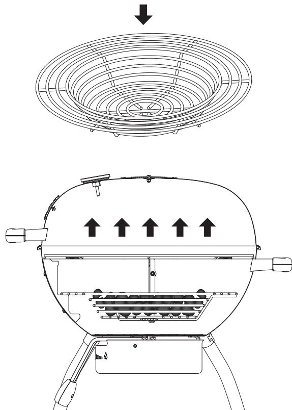
Vid behov kan locket vara öppet vid denna tillagningsmetod, eller tas bort. Om du vill ta bort locket avlägsnar du sprinten i lockets gångjärn när grillen är kall och drar ut förbindelsebulten ur gångjärnshalvorna. Skjut in sprinten i bultarna igen och förvara dem på en säker plats. Locket kan nu inte användas igen förrän grillen svalnat. Vid behov monterar du tillbaka locket på den kalla grillen.
