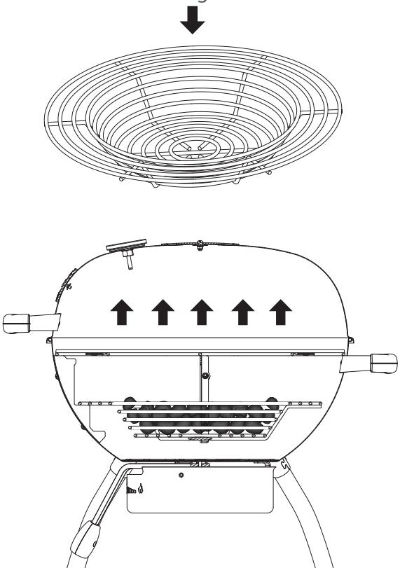
Si nécessaire, le couvercle peut rester ouvert pour cette méthode de cuisson, ou même être démonté. Pour ce faire, retirez la goupille sur la charnière du couvercle à l'état froid du barbecue, puis retirez l'axe d'assemblage des demi-charnières. Réinsérez à présent la goupille dans l'axe et conservez-les de façon sûre. A présent le couvercle ne peut plus être utilisé jusqu'à ce que le barbecue soit à nouveau refroidi. Si nécessaire, remontez le couvercle sur le barbecue froid.
