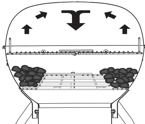
**Hinweis:** Bei Fleisch, das länger als eine Stunde Garzeit benötigt, muss bei Bedarf weitere Holzkohle an den Seiten zugeführt werden (siehe folgende Tabelle). Durch die aufklappbaren Grillroste kann einfach Holzkohle nachgefüllt werden. Warten Sie ca. 10 min. bei offenem Deckel bis diese vollständig brennen. Danach den Deckel wieder schließen und den Garprozess fortsetzen.
