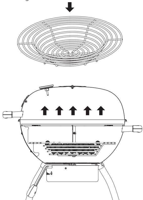
Indien gewenst kan voor deze bereidingsmethode het deksel geopend blijven of gedemonteerd worden. Daarvoor verwijdert u in koude toestand van de barbecue op het dekselscharnier de splitpen en trekt u de verbindingsbouten uit de scharnierhelften. Nu de splitpen weer in de bouten schuiven en veilig bewaren. Het deksel kan nu niet meer gebruikt worden, tot de barbecue weer is afgekoeld. Indien gewenst het deksel weer op de afgekoelde barbecue monteren.
