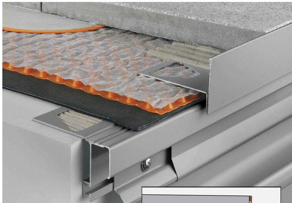
Das Profil bewirkt einen optisch sauberen Randabschluss und deckt die Fliesenkanten sowie die freien Estrichkanten ab.
