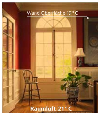
Nach der Innendämmung: Wärme Wände schaffen Behaglichkeit schon bei geringerer Raumtemperatur.
