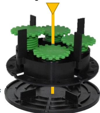
Abbildung 3: Alle Volfiplatten Ausführungen lassen sich als unterstes Element im Volfiteller System (wie hier) zur 5mm Erhöhung oder in gummierter Ausführung als Entkoppelung einsetzen.
